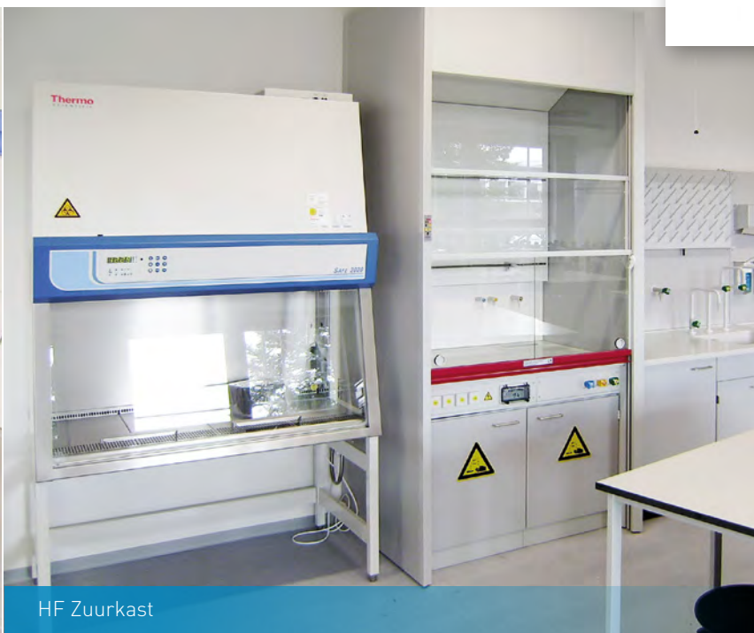
VAV zuurkast met automatisch sluitsysteem
